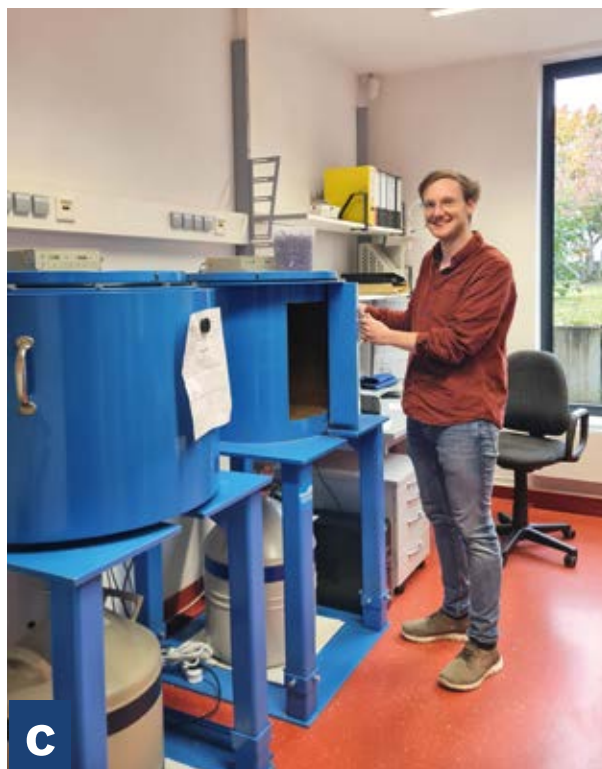
Abbildung 84 a–c: Küchentechnische Vorbereitung der Proben (links), radio-chemische Probenvorbereitung zur Betaspektrometrie (rechts) und Gammadetektoren mit dickem Bleimantel (unten)
