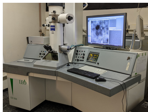
Abbildung 123 Das Elektronenmikroskop TEM LEO 906 E von Zeiss
