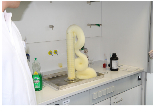
Durch die Mischung von Geschirrspülmittel, Wasserstoffperoxid und Kaliumiodid kommt es zur Bildung von Sauerstoff und Wasserdampf, welche für das Aufschäumen des Geschirrspülmittels sorgen. Es entsteht „Elefantenzahnpasta“.
