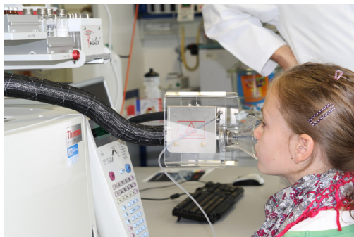
Sniffing-Port-Detektor: Die menschliche Nase als Detektor für die Gaschromatographie. Hier versucht ein kleines Mädchen ein Chromatogramm „abzuriechen“.
